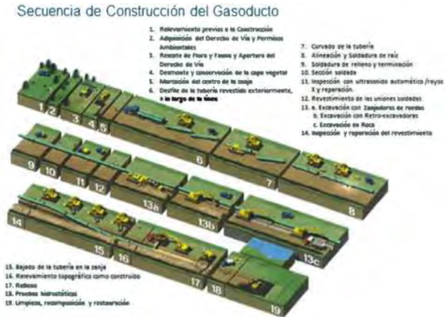
Ilustración 2 Secuencia de construcción del proyecto
